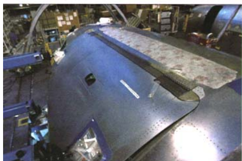
采用壁板柔性定位技术的波音737机身壁板的装配定位
